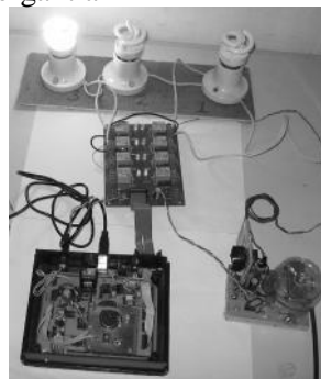
Gambar 4. Pengujian perangkat keras sistem pengendali lampu otomatis.
