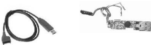
Gambar 2. Modifikasi kabel data Nokia CA-42.
